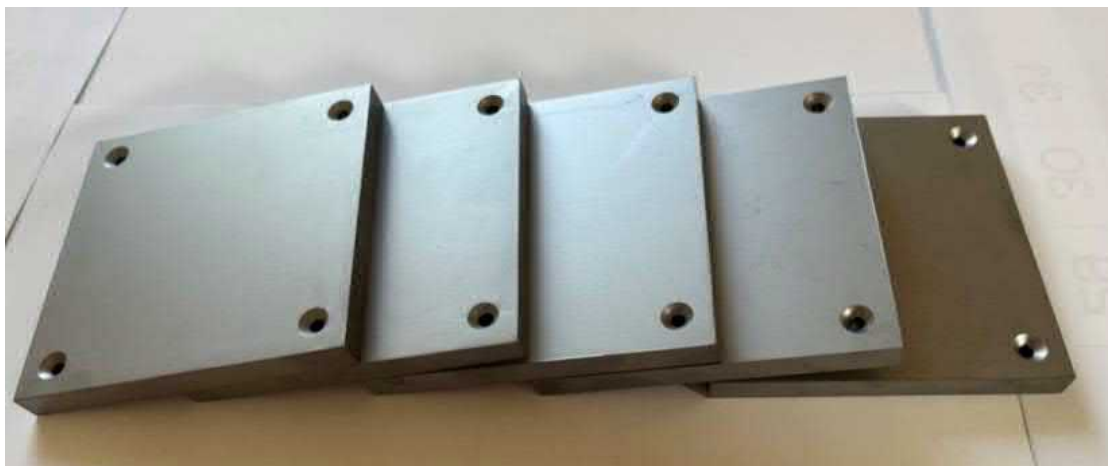
Рис. 1. Опытные макеты теплозащитной облицовки из бериллия марки ТГП-56ПС перед испытаниями
